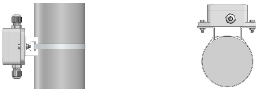
Рисунок 7. Крепление ВД на опоре ограждения
