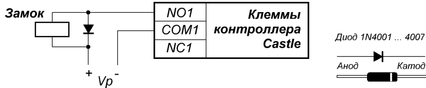
Рисунок 18. Пример подключения электромеханического замка для первой двери.
