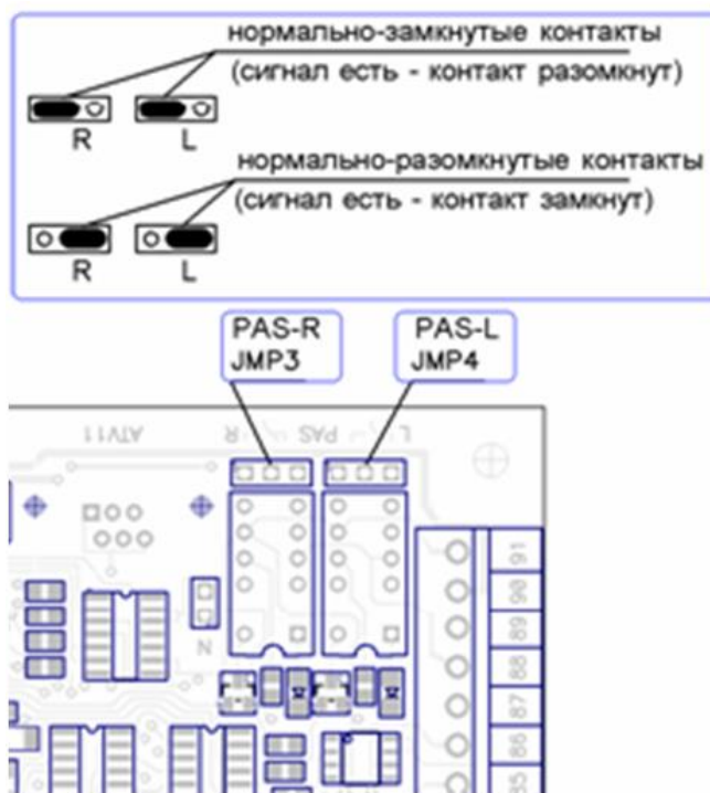
Рисунок 51. Перемычки JMP3 и JMP4 контроллера OMA-DD.958, OMA 264MC1.
