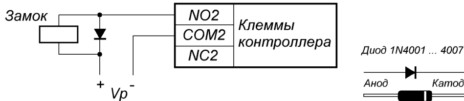
Рисунок 22. Пример подключения электромеханического замка для первой двери.
